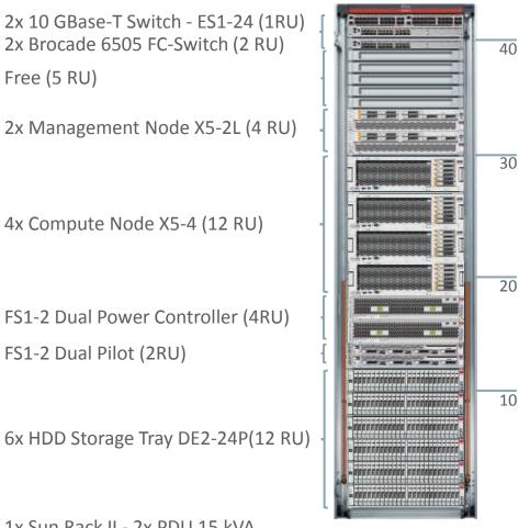
1x Sun Rack II - 2x PDU 15 kVA
